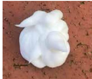
KÖSTER Crisin Creme ma stabilną konsystencję. Dlatego nawet jeżeli do otworu podana zostanie zbyt duża ilość materiału krem iniekcyjny nie spływa po ścianie i nie powstają ciemniejsze ślady zacieków na tynku. Nadmiar materiału należy usunąć szpachelką a otwór bez zwłoki zamknąć zaprawą KB FIX 5.
