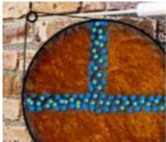
Standardowy krem: Substancja aktywna miesza się z wodą zawartą w porach zawilgoconej ściany. Substancja aktywna ulega rozcieńczeniu i dochodzi do niekontrolowanego rozłożenia aktywnej substancji w materiale ściany
