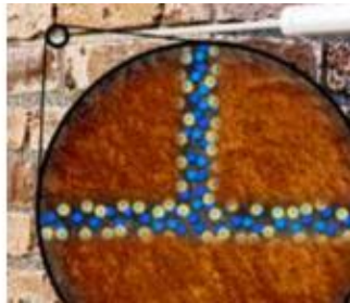
KÖSTER Crisin Creme: Materiał jest emulsją wody w oleju dlatego substancja aktywna nie miesza się z wodą. Woda jest stopniowo wypierana z kapilarów.
